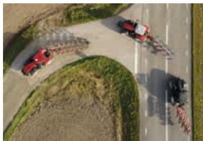
Für höchste Sicherheit im Straßenverkehr folgt der Pflug dem Schlepper wie ein Anhänger. Dies entlastet Schlepper und Fahrer.
