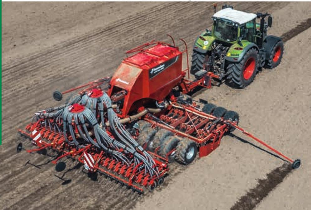
Moderne Pflanzenbausysteme erfordern neue Denkweisen. Mit der u-drill plus kann Dünger während der Aussaat gezielt ausgebracht werden. Zusätzlich ermöglicht das System auch eine intelligente Etablierung von Untersaaten oder Zwischenfrüchten.
