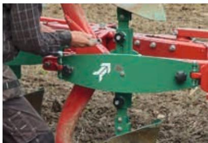
Die zentrale Einstellung der Vorwerkzeuge spart Zeit. Für perfektes Pflügen werden je zwei Einleger gleichzeitig eingestellt.
