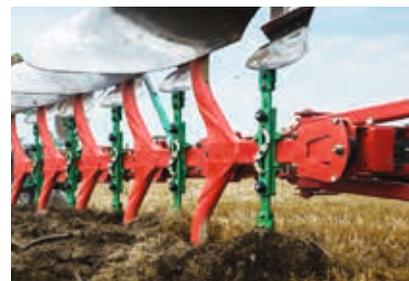
Die Grindel mit Aero-Profil ermöglicht ein verstopfungsfreies Arbeiten beim Pflügen von Flächen mit großen Mengen an Ernterückständen oder Bewuchs.
